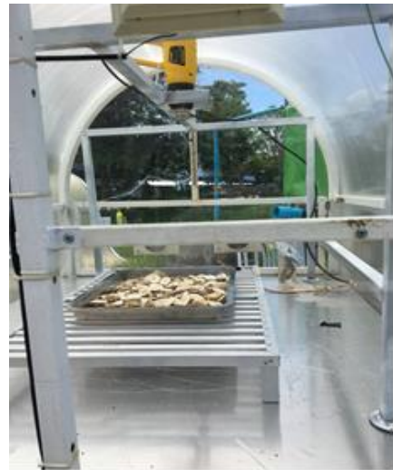
รูปที่ 1 โรงเรือนอบแห้งพลังงานแสงอาทิตย์พร้อมระบบเสริมความร้อน
