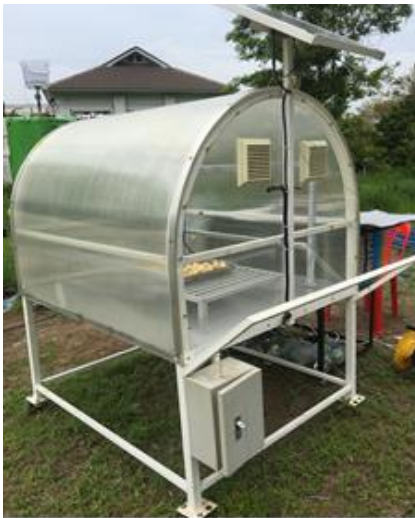
รูปที่ 1 โรงเรือนอบแห้งพลังงานแสงอาทิตย์พร้อมระบบเสริมความร้อน
