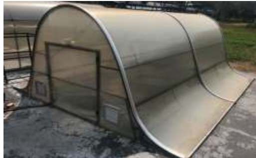
รูปที่ 1 โรงเรือนอบแห้งรูปทรงพาราโบลาเพิ่มพื้นที่รับแสงอาทิตย์ด้านข้าง
