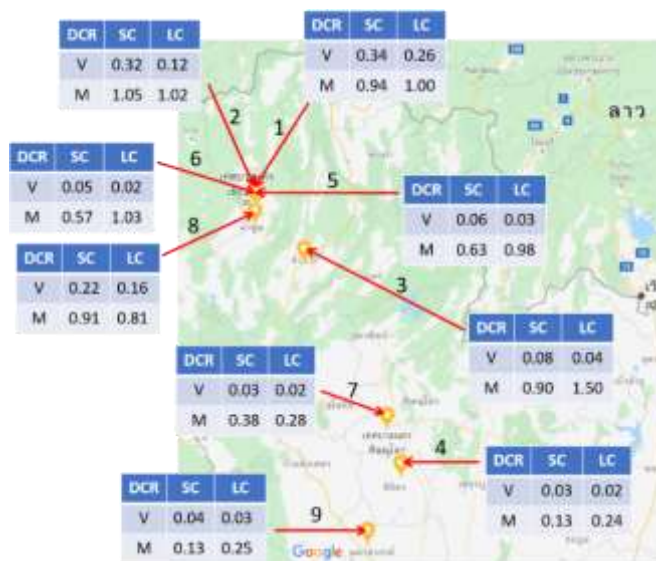
รูปที่ 9 ที่ตั้งและอัตราส่วนความต้องการต่อวิสัยสามารถ ( DCR ) ของแรงเฉือนและโมเมนต์ดัด เสาสะพานบริเวณภาคเหนือและตะวันตก
