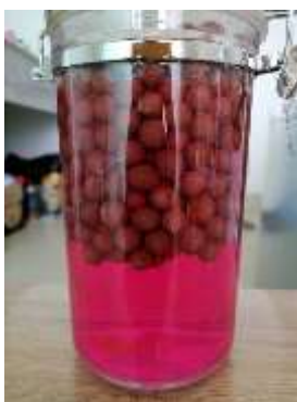
รูปที่ 6 การแช่เม็ดดินเผาในสารละลายเฟอร์ริกคลอไรด์
