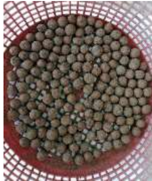
รูปที่ 4 เม็ดดินเผาหลังผ่านการใช้ดูดซับก๊าซไฮโดรเจนซัลไฟด์ในก๊าซชีวภาพ
