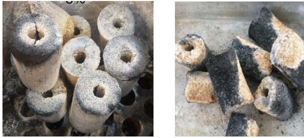
รูปที่ 23 ลักษณะเก่าของเชื้อเพลิงอัดแท่งหลังจากการเผาไหม้
