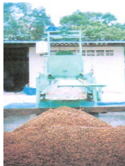
รูปที่ 6 การทำงานของเครื่องล้างเมล็ดพริกไทย
