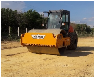
รูปที่ 2 ลักษณะของรถบดล้อเหล็กที่ใช้ในโครงการวิจัยนี้ น้ำหนัก 19 ตัน
