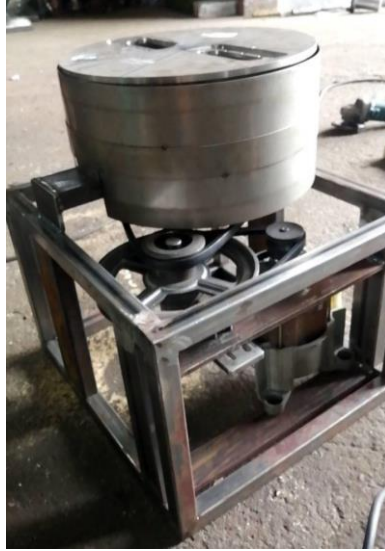
รูปที่ 8 ติดตั้งมู่เล่ สายพานและจานใบมีดเข้ากับฐานเครื่อง
