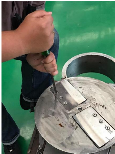
รูปที่ 7 ติดตั้งใบมีดเข้ากับงานใบมีด
