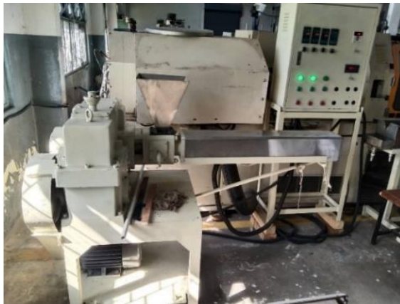
รูปที่ 4 เครื่องอัดรีดแบบสกรูเดี่ยว (Single screw extruder)
