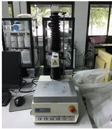
รูปที่ 6 เครื่องวัดสมบัติเนื้อสัมผัสและหัวกด Texture Profile Analysis
