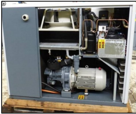
ภาพที่ 2 เครื่องอัดอากาศ Air Compressor 50-100HP.
