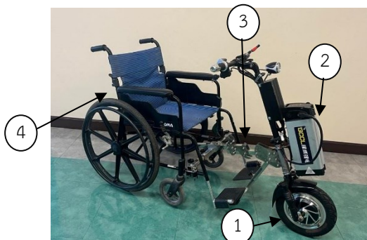
ภาพที่ 3 แสดงส่วนประกอบชุดหัวลากไฟฟ้าสำหรับรถเข็นคนพิการ
