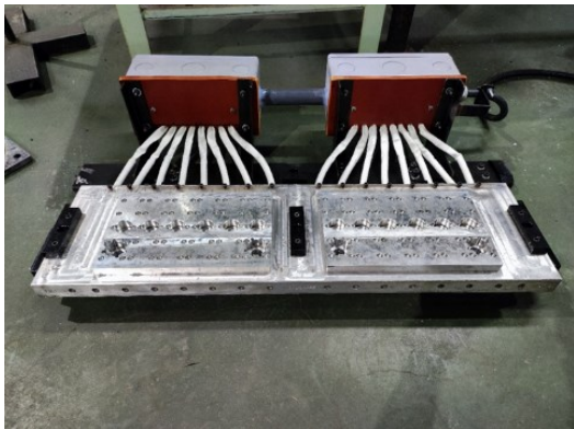
ภาพที่ 6 HEAESEAL N70 วัสดุอลูมิเนียม7022 ตัวใหม่ที่มีการระบุวันที่และจำนวนลูกในการผลิต
