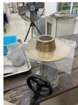
ภาพที่ 1 การทดสอบการไหลแผ่ของมอร์ตาร์โดยวิธีใช้โต๊ะการไหล
