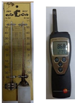
รูปที่ 3 ไฮโครมิเตอร์และเครื่องอ่านค่าแบบดิจิทัล
