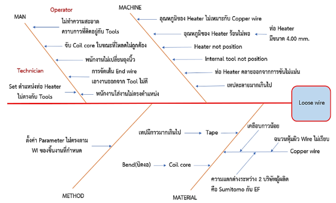
ภาพที่ 4 แผนภูมิก้างปลา Loose wire
