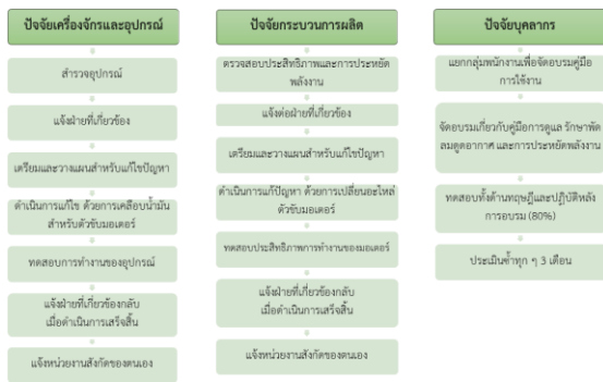
แผนภาพที่ 2 วิธีการแก้ปัญหาการเกิดสนิมที่ตัวขั้วบวมเตอร์
