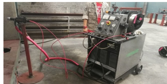
ภาพที่ 2 เครื่องพ่นเคลือบแบบอาร์คสเปรย์ รุ่น Tafa 400
