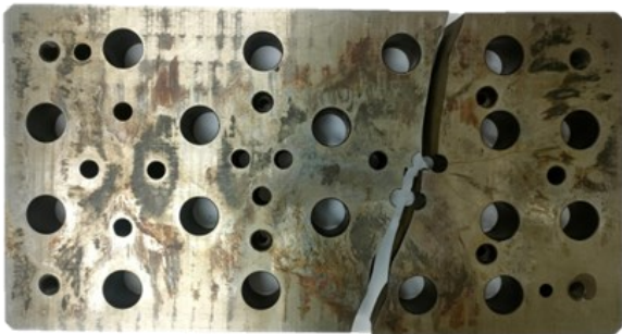
ภาพที่ 1 แม่พิมพ์ตายขึ้นรูปที่แตกหัก
