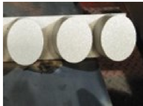
ภาพที่ 2 ชิ้นงานหลังพ่นทรายเสร็จ
