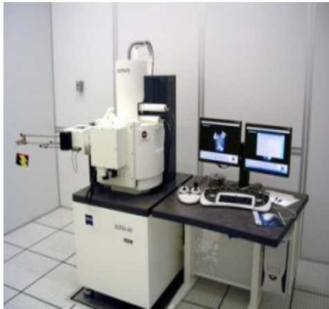
ภาพที่ 4 การตรวจสอบโครงสร้างจุลภาคของชิ้นงาน
