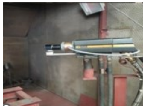
ภาพที่ 3 ปืนพ่นเคลือบ ( Spray Gun ) รุ่น JP-5000
