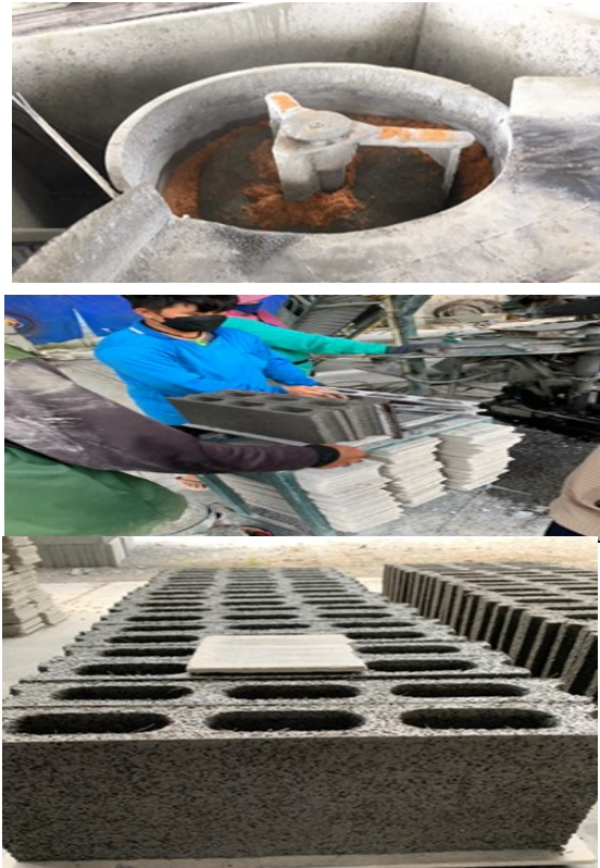
ภาพที่ 3 การเตรียมตัวอย่างส่วนผสมและการขึ้นรูป
