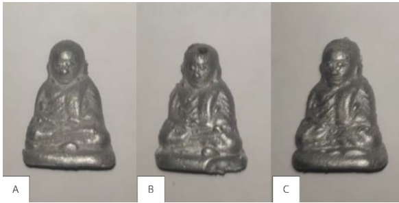
ภาพที่ 4 แสดงลักษณะสมบรูณ์ของชิ้นงาน ที่ผ่านการหล่อที่เวลาแตกต่างกัน (A) 30 วินาที (B) 60 วินาที (C) 90 วินาที
