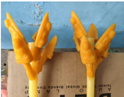
ภาพที่ 2 ข้อเทียนที่ใช้สำหรับทำแบบหล่อซีดีฟิ่งหายน
