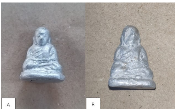
ภาพที่ 3 (A) แสดงชิ้นงานที่มีลักษณะสมบูรณ์ (B) ชิ้นงานที่มีลักษณะไม่สมบูรณ์
