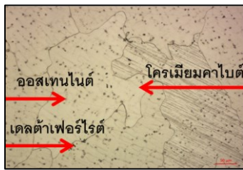
ภาพที่ 13 โครงสร้างจุลภาคบริเวณแนวเชื่อม (Weld zone)
