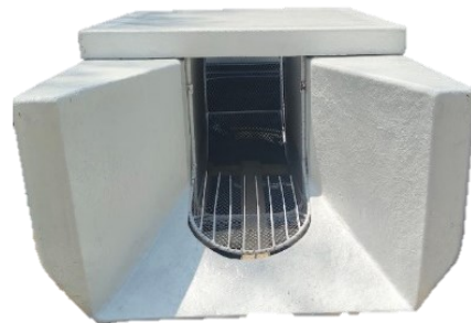
ภาพที่ 5 เรือต้นแบบเก็บขยะที่สร้างเสร็จสีขาว ด้านบนมีฝาปิดเรือ ด้านหน้ามีลวดสำหรับกันขยะ
