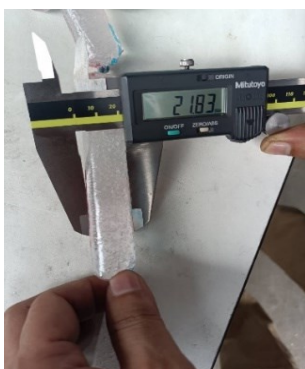
ภาพที่ 13 การวัดขนาดเส้นผ่านศูนย์กลางของลูกไส้กรอก 21 \pm 2 มิลลิเมตร
