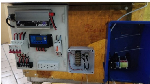
รูปที่ 2 Solar Charger และอุปกรณ์ที่ติดตั้งกับตู้ฆ่าเชื้อไวรัสโคโรนา (Covid-19) อัจฉริยะแบบไฮบริด
