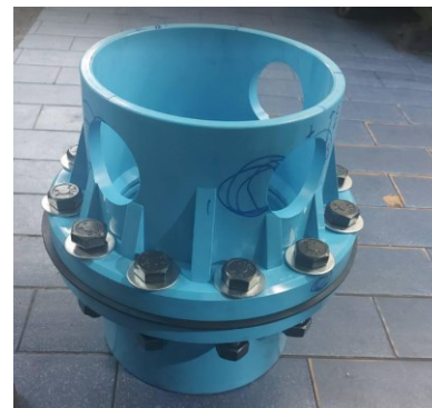
ภาพที่ 4 ประกอบแป้นทั้งสองอันเข้าหากันและยึดสกรู
