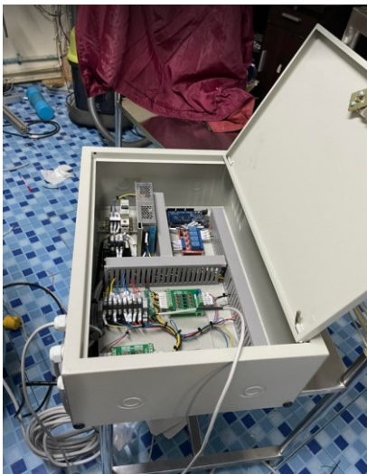
ภาพที่ 6 เดินระบบไฟและประกอบเข้ากับกล่องควบคุม
