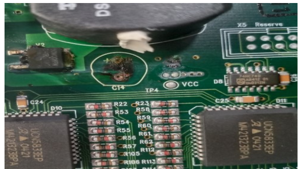
ภาพที่ 6 การชำรุดที่แผงวงจรอิเล็กทรอนิกส์
