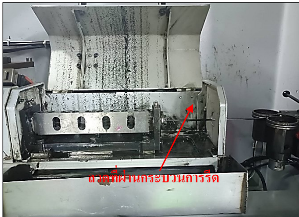
ภาพที่ 8 กระบวนการรีดลวดสปริงเพื่อให้เป็นเส้นตรง
