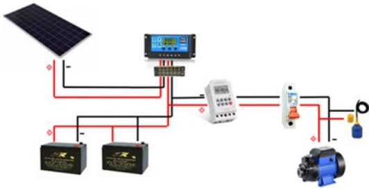
ภาพที่ 4 การออกแบบไดอะแกรมวงจรไฟฟ้า ในระบบปั้มน้ำอัจฉริยะ
