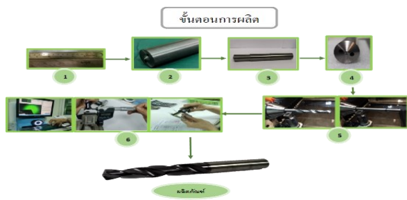
ภาพที่ 7 กระบวนการผลิตสแตปปีวส่วนทั้งสแตนคาร์ไบด์
