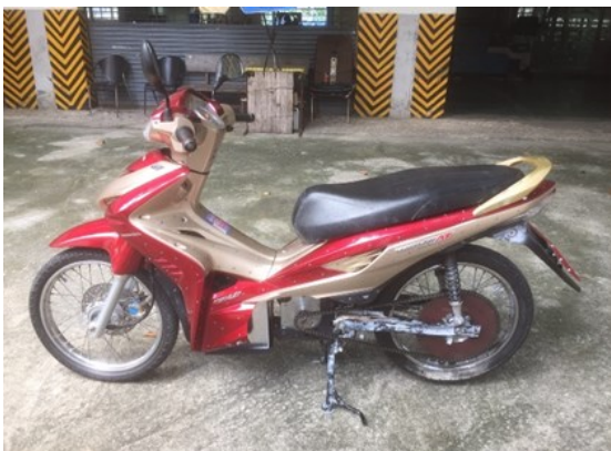
ภาพที่ 9 มอเตอร์ชุดขับเคลื่อนและแบตเตอรี่ที่ติดตั้งเข้ากับจักรยานยนต์ไฟฟ้า
