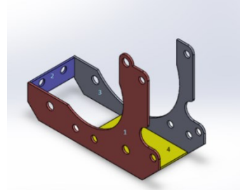
ภาพที่ 1 โครงสร้างชุดยึดมอเตอร์แบบอินดักชันขนาด 4 kW
