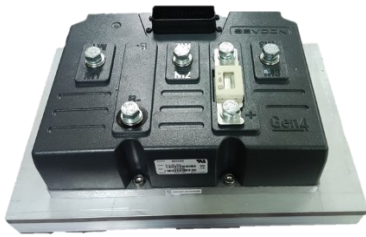
ภาพที่ 5 อุปกรณ์ควบคุมมอเตอร์ไฟฟ้าแบบอินดักชัน (IM)
