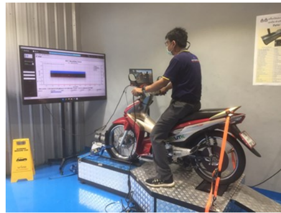
ภาพที่ 10 การทดสอบสมรรถนะของจักรยานยนต์ไฟฟ้าดัดแปลง
