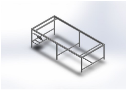
ภาพที่ 2 แบบภาพแสดงลักษณะฐานวางแผง 3 มิติ ของเครื่องทำความสะอาดแผงโซลาร์เซลล์
