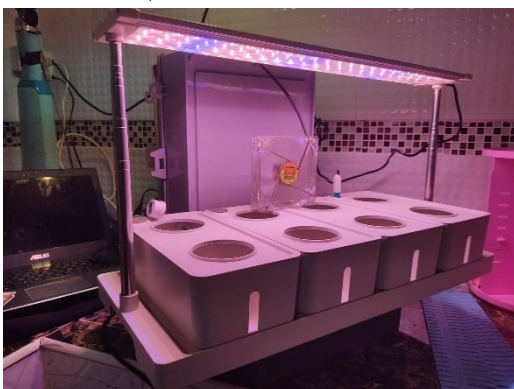
ภาพที่ 4 สมาร์ตไฮโดรโปนิคส์ควบคุมผ่าน Application Blynk ที่สร้างเสร็จและพร้อมสำหรับการทดลอง
