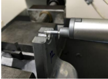
รูปที่ 11 ทำการวัดค่าความหยابผิวชิ้นงาน
