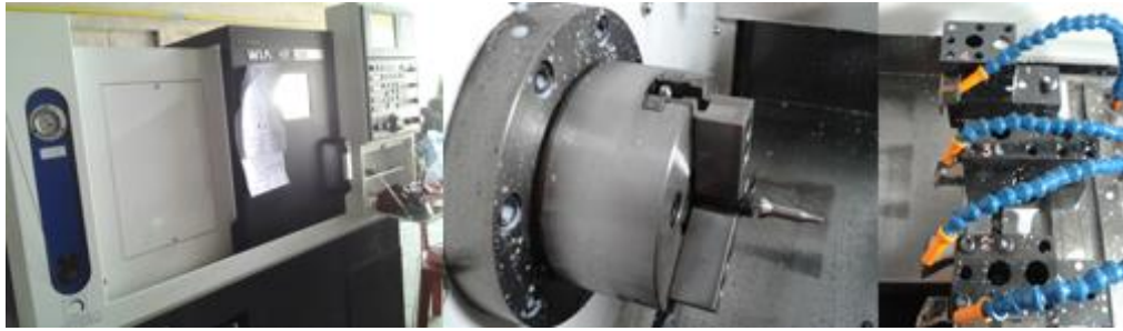
รูปที่ 1 เครื่องกลึงอัตโนมัติ การจับยึดชิ้นงานและเครื่องมือตัด
