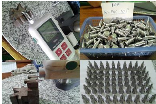
รูปที่ 3 การวัดค่าความหยابผิวชิ้นงานด้วยเครื่องวัดความหยابผิว
