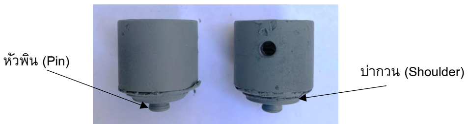
รูปที่ 3 หัวกวนของอุปกรณ์การเชื่อมเสียดทานแบบกวนแบบหัวกวนคู่
