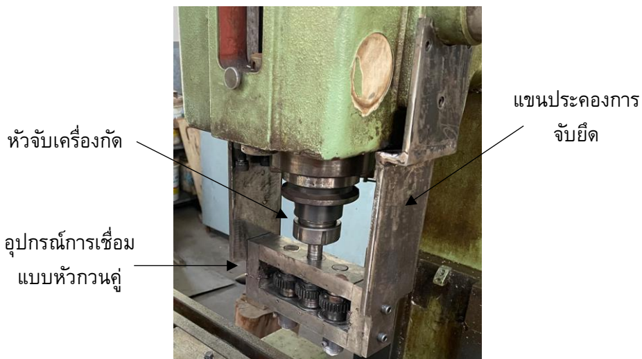
รูปที่ 4 การประกอบอุปกรณ์การเชื่อมเสียดทานแบบกวนแบบหัวกวนคู่
