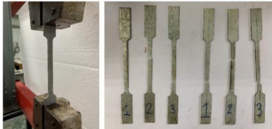
รูปที่ 4 การทดสอบคุณสมบัติแรงดึงของเหล็กเคลือบสังกะสี
